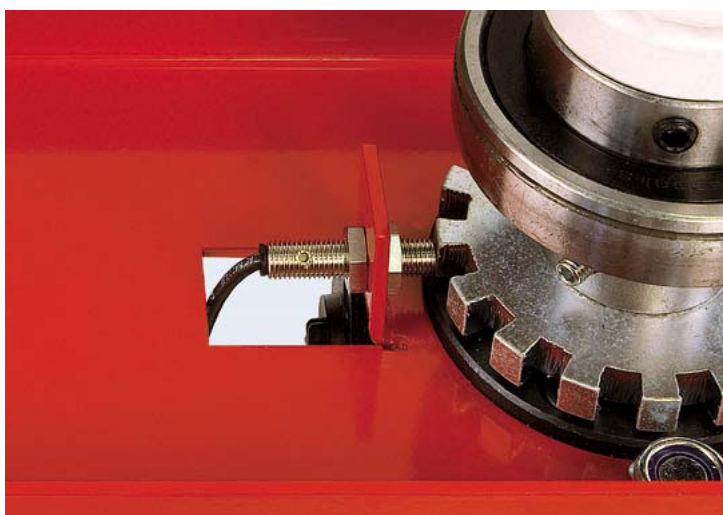
Бесконтактный сенсор для считывания числа оборотов, износостойкий и неприхотливый
